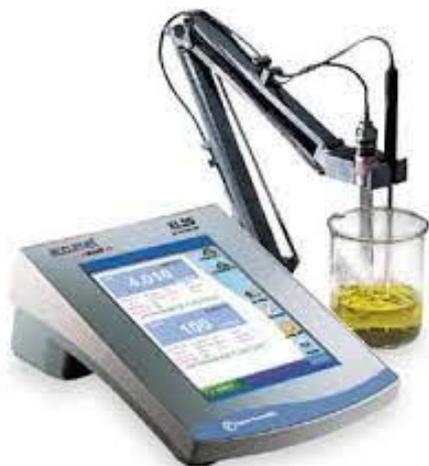
Fig. 03: Imagen Referencial - Conductímetro
